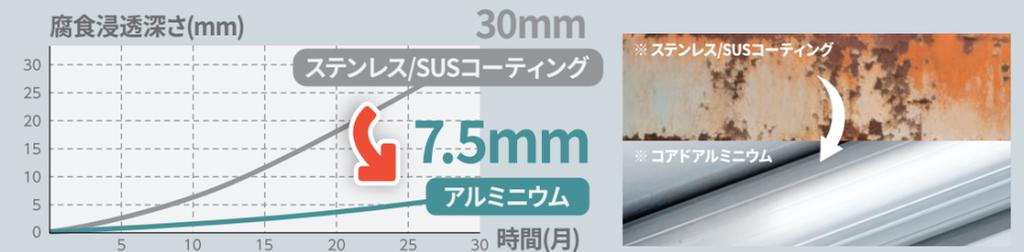
経年変化による腐食浸透深さのテストで、ステンレスを上回る防錆、防食効果が実証されました。(※当社調べ)
